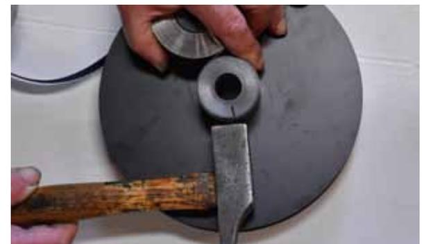
6. Le plier avec un marteau, jusqu'à ce que la languette soit bien enfoncée dans la rainure.
