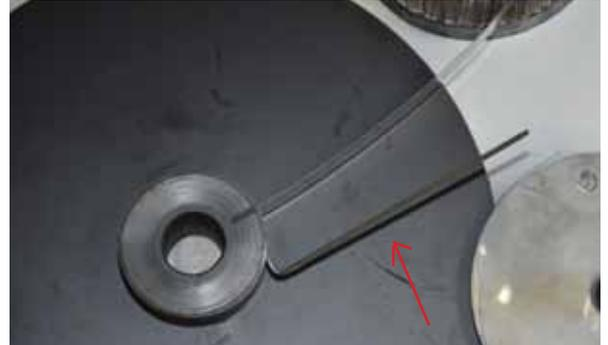
5. Retenir le ressort et presser dans le sens des aiguilles d'une montre.
