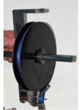
14. Retourner et, tenir le mécanisme entre les jambes et serrer la vis (pas trop fort). Contrôler si le ressort tourne facilement.
