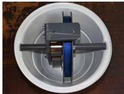
18. Placer le joint dans la rainure de la bouée et relier les 2 extrémités de ce joint afin qu'elles soient collées ensemble.
