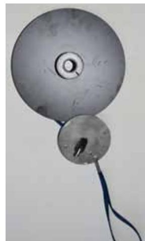
3. Mettre le ressort sur une cale de la même épaisseur que le disque afin de positionner le début du ressort dans la rainure de l'axe central.
